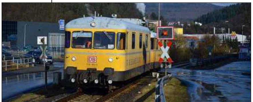
Ein Gleismesszug auf der Dietzhöhlzalbahn bei Dillenburg Stahlwerk, März 2015. (Foto: Martin J. Conrad)
